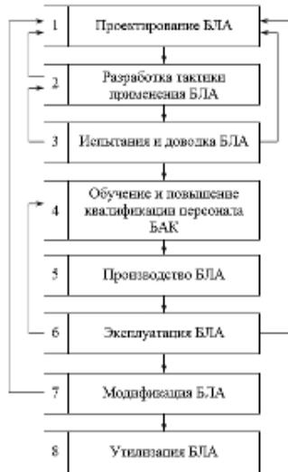
Рисунок 2 – Жизненный цикл БПЛА
