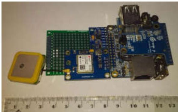
Рисунок 3 – Тестовая схема комплекса управления БПЛА
