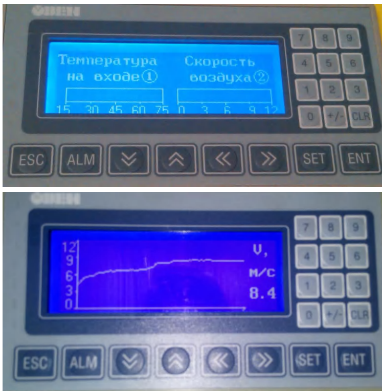
Рисунок 3 – Главный экран панели оператора ИП320 и график изменения скорости потока воздуха
