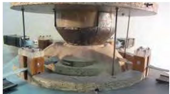
Рисунок 2 – Физическая модель выгрузочного устройства, оснащенного ножами-скребками: а – общий вид; б, в – нейтральное положение элементов устройства в режиме холостого хода и при действии номинальных нагрузок соответственно
