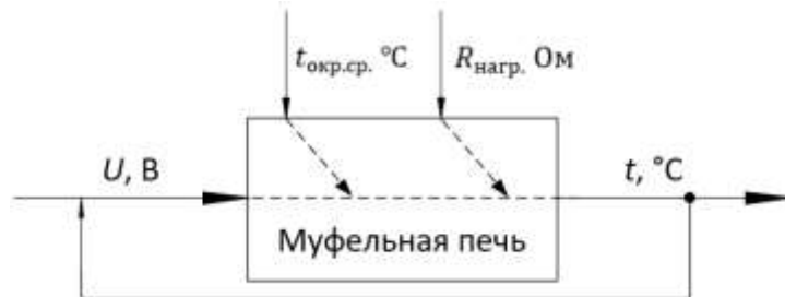
Рисунок 1 – Схема муфельной печи, как объект управления
