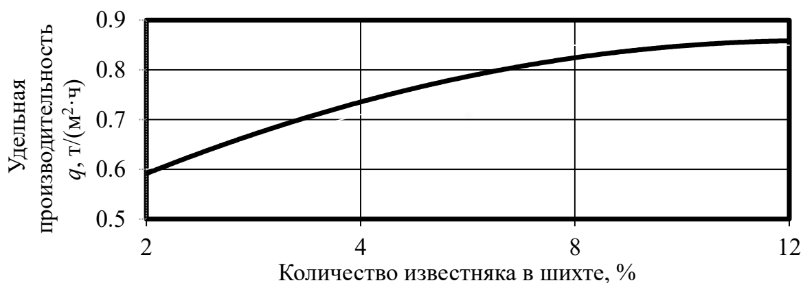
Рисунок 1 – Влияние содержания известняка в шихте на удельную производительность агломерационной машины
