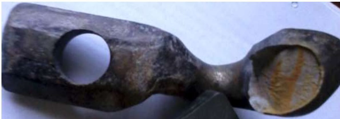
Рисунок 2 – Внешний вид излома на соединительном звене
