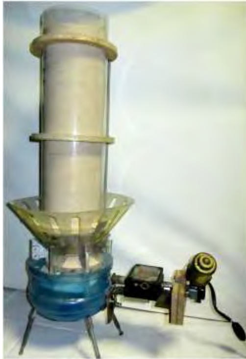
Рисунок 1 – Физическая модель выгрузочного устройства со столом, совершающим плоскопараллельное движение
