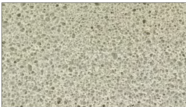
Рисунок 1. – Структура бетонного камня с добавлением измельченного стекла
