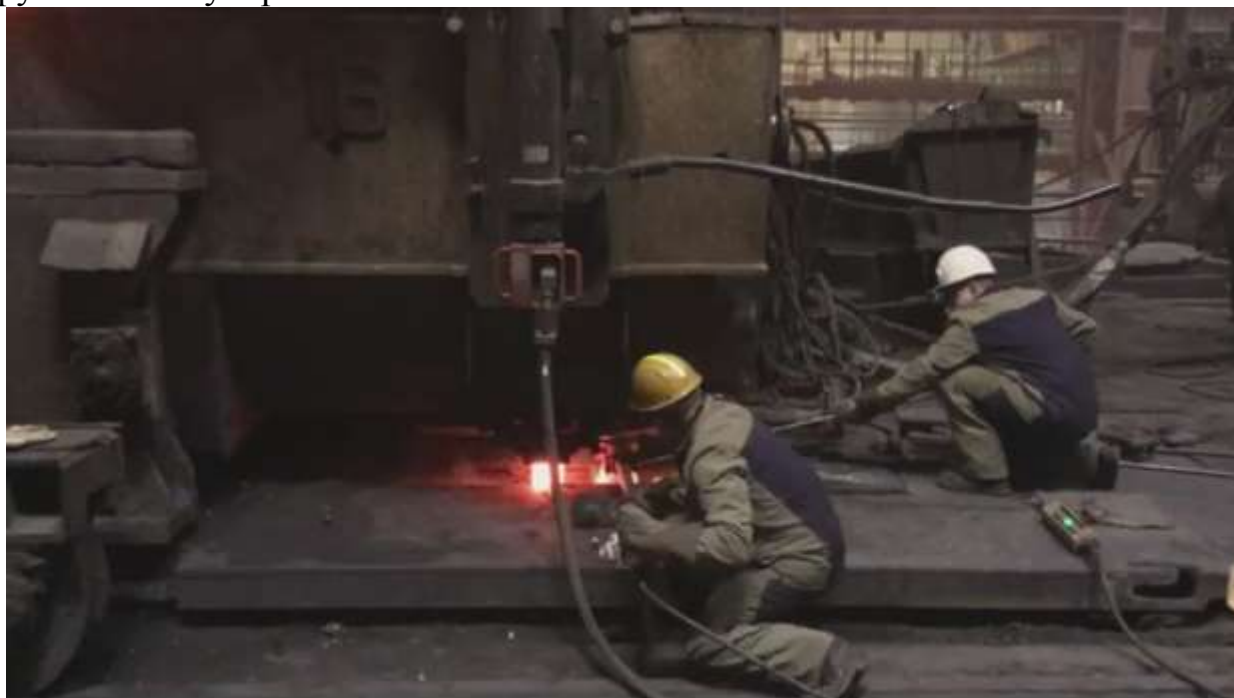
Рисунок 5 – Замена погружного стакана на слябовой МНЛЗ в цехе разливки конвертерной стали ПАО «Северсталь» (г. Череповец, РФ)
