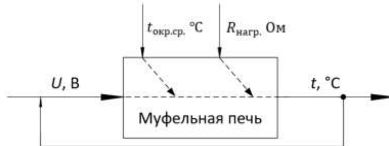
Рисунок 1 – Схема муфельной печи, как объект управления
