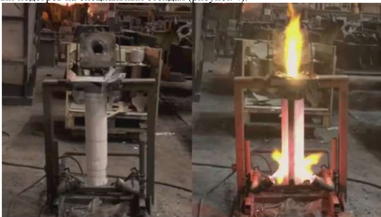
Рисунок 4 – Общий вид стенда для разогрева погружного стакана
