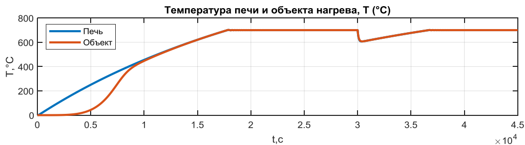
Рисунок 4 – Переходные характеристики САУ температуры
