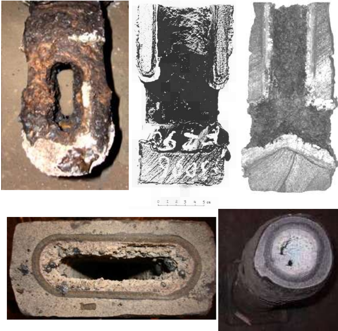
Рисунок 1 – Общий вид отложение тугоплавких соединений на внутренней поверхности глуходонных (верхний ряд) и прямоточных (нижний ряд) погружных стаканов [2, 3]
