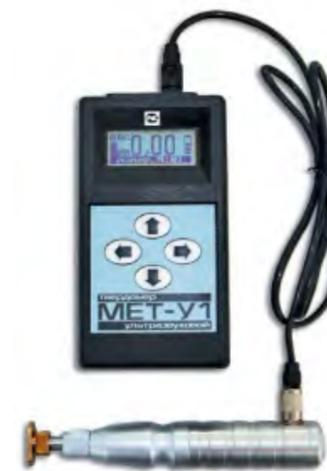
Прибор предназначен для измерения твёрдости металлов и сплавов по стандартизованным шкалам твёрдости Роквелла (HRC), Бринелля (HB), Виккерса (HV) и Шора (HSD).
