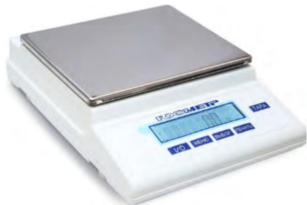
Весы лабораторные электронные неавтоматического действия ВЛТЭ предназначены для статических измерений массы предметов, материалов, сыпучих и жидких веществ.
