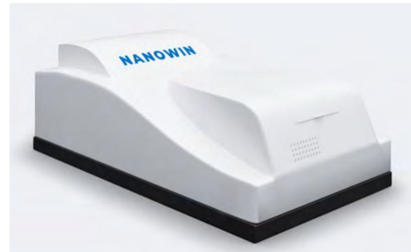
Позволяет диагностировать размеры частиц дисперсной фазы в коллоидных системах (золи, растворы, суспензии, эмульсии и т.д.) в диапазоне от 1 до 10000 нм. Принцип работы Nanowin основан на методе динамического светорассеяния и анализе автокорреляционной функции для вычисления коэффициентов диффузии и распределения частиц по гидродинамическому диаметру.
