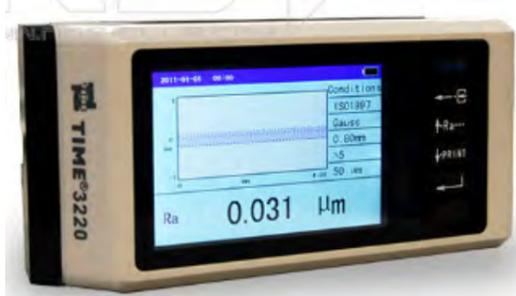
Прибор предназначен для измерения шероховатости поверхности по 40 шкалам, для измерения поверхностей всех видов металлов и неметаллов. Прибор оснащен выносным датчиком. Профилометр TIME3220 имеет высокую точность и широкий диапазон применения.
