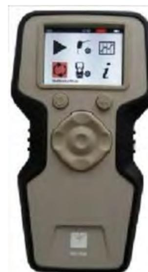
Предназначен для измерений теплопроводности и теплового сопротивления, температуропроводности и теплоемкости строительных, теплоизоляционных и прочих материалов.
