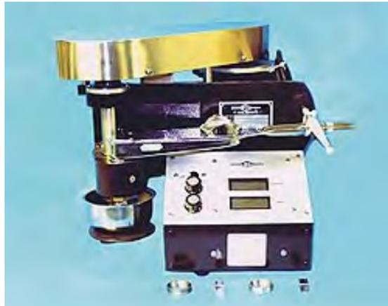
Комбинированный тестер предельного давления (ПД) и смазывающей способности - это высококачественный прибор, используемый для измерения смазывающей способности буровых растворов, получения данных для определения типа и количества смазочных добавок и скорости износа механических деталей в известных системах флюидов буровых растворов.
