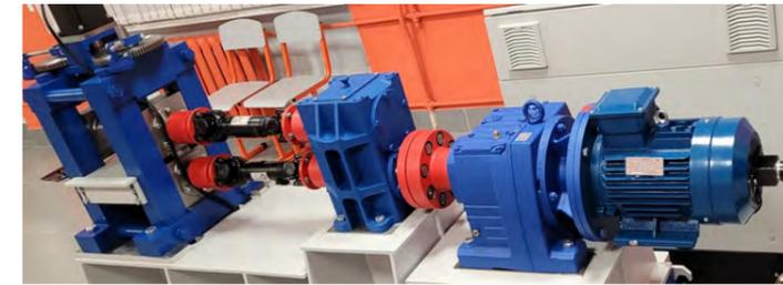
Комплект оборудования лабораторного прокатного стана дуо-130 предназначен для лабораторных работ по курсам «Обработка металлов давлением», «Теория обработки металлов давлением», «Механическое оборудование цехов ОМД» и др. Кроме того, он предназначен для проведения научно-исследовательских работ по изучению особенностей пластической деформации, физического моделирования процессов прокатки, проверке адекватности математических моделей, созданию цифровых двойников при 3D моделировании.
