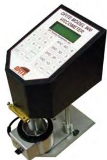
Вискозиметр представляет собой портативный и полностью автоматизированный прибор, предназначенный для определения реологических свойств буровых и тампонажных растворов, а также жидкостей, используемых при производстве гидроразрыва пласта (ГРП).
