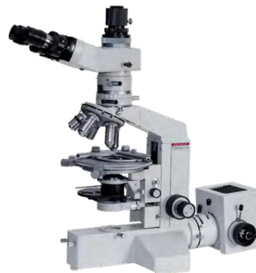
Микроскоп предназначен для исследований прозрачных объектов в проходящем свете – обыкновенном и поляризованном.
