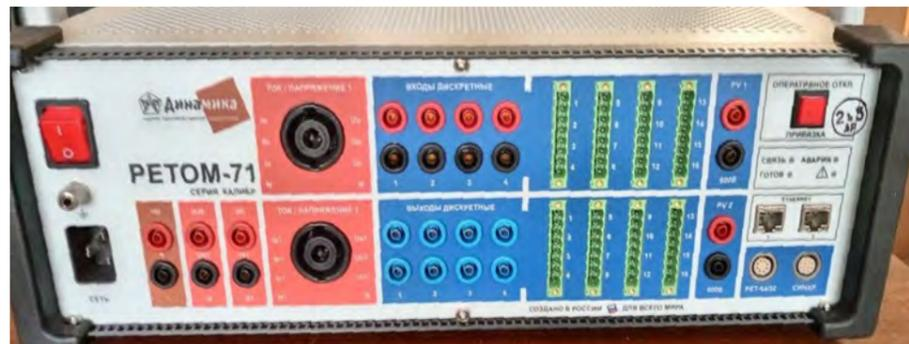
РЕТОМ-71 – первый испытательный комплекс серии «Калибр» в линейке РЕТОМ, ориентированный на проведение высокоточного тестирования сложных современных защит, а также метрологической поверки счетчиков электроэнергии и т. д.
