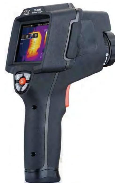
Тепловизор воспринимает тепловую энергию поверхности объекта и использует ее для расчета значений температуры. Измерение температуры с помощью тепловизора производится косвенно, на основании измерения излучаемой тепловой энергии поверхности. Рабочий диапазон от  $-20^{\circ}\text{C}$  до  $400^{\circ}\text{C}$  с точностью  $\pm 2^{\circ}\text{C}$ . Распределение температуры отображается на дисплее прибора, как цветная картинка, где разным температурам соответствуют разные цвета.
