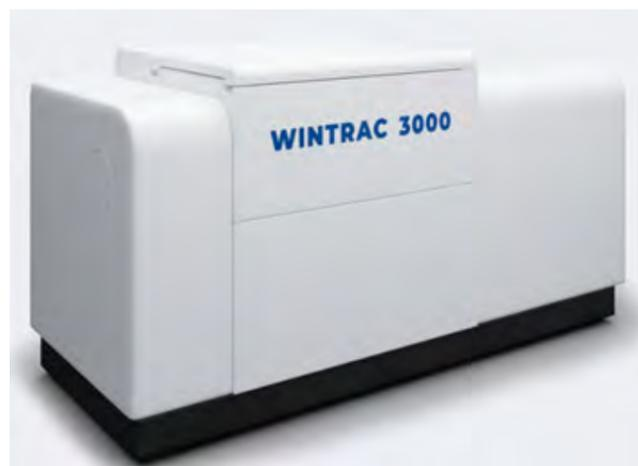
Грануломер - это прибор, используемый для измерения и анализа размеров частиц в различных материалах. Грануломеры широко применяются в различных отраслях, включая геологию, строительство, фармацевтику, пищевую промышленность, химию и другие, где точное знание размеров частиц является важным параметром.
