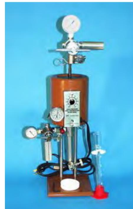
Фильтр-пресс высокого давления и температуры предназначен для тестирования буровых растворов при повышенных температурах и давлениях в соответствии со стандартами API RP 13B / ISO 10414.
