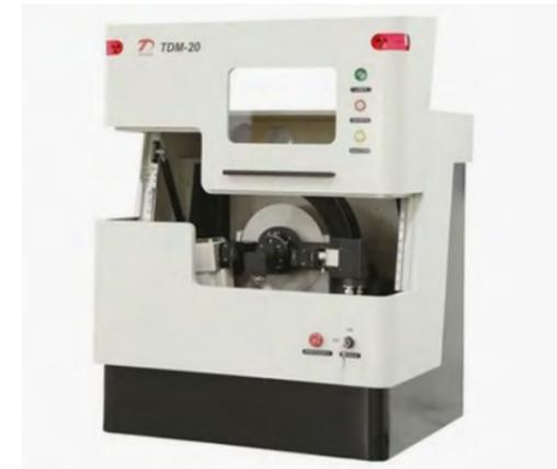
TDM-20 является многофункциональным настольным дифрактометром для решения широкого круга задач порошковой дифрактометрии: качественный и количественный фазовый анализ, определение параметров элементарной ячейки, размера кристаллитов, степени кристалличности, высокоскоростная съемка образа. Рентгеновский дифрактометр TDM-20 в настольном исполнении используется для
