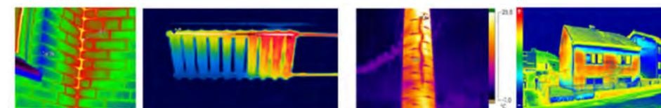
Эти данные можно использовать при приемке сооружений у строителей (при сдаче приемочной комиссии нового или отремонтированного здания), при проверке строительных конструкций на соответствие нормативом теплоизоляции.
