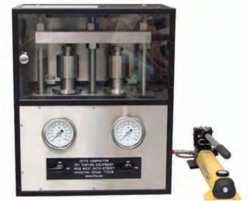
Исследование характеристик набухания глинистых сланцев важно при выборе бурового раствора, который должен обеспечить максимальное ингибирование и стабильность буровой скважины. Если буровой раствор не полностью совместим с пластом, то в процессе бурения скважины глина сразу начнет набухать. В результате набухания могут возникнуть проблемы следующего характера: налипание породы на долото, сопротивление трубы, обрушение стенок скважины и т.д.
