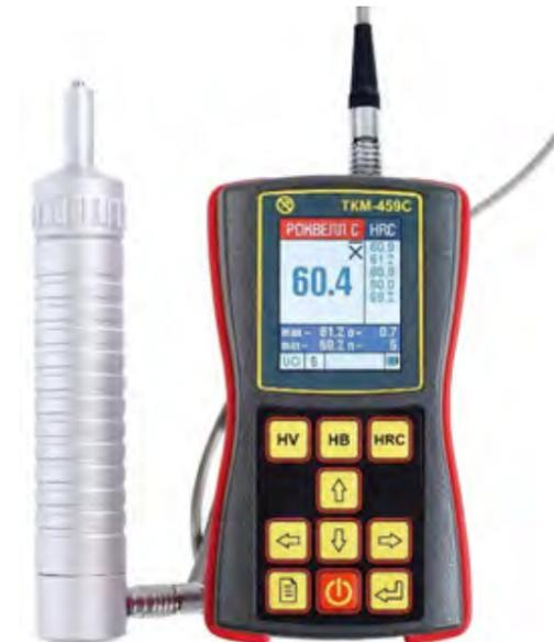
Ультразвуковой твердомер ТКМ-459С – это портативный высокоточный прибор для оперативного измерения твердости металлов и металлических изделий. Измерения производятся в основных единицах твердости HRC, HB, HV. Так же возможен контроль по шкалам HRA, HRB, HSD и пределу прочности (МПа, пересчет по ГОСТ 22791-77). Предусмотрена возможность программирования пользователем собственных шкал.
