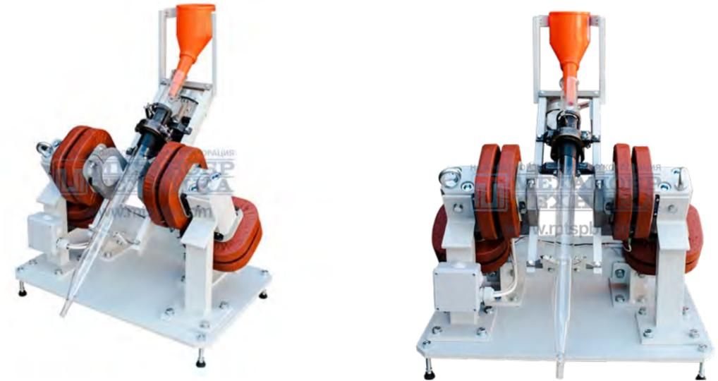
Предназначен для мокрого магнитного анализа сильномагнитных руд и продуктов магнитной сепарации, а также для определения содержания сильномагнитной фракции в различных продуктах.
