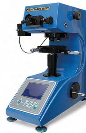
Стационарный цифровой твердомер NOVOTEST TC-MKB используется для измерения твердости различных материалов по шкале микро Вickers. Этот прибор имеет большой контрастный дисплей, он крайне удобен и прост в эксплуатации и настройке.
