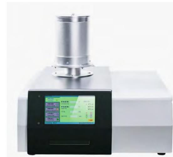
ZXF-A – это термогравиметрический анализатор исследовательского класса. Благодаря верхнему расположению весового механизма термоданализатор ZXF-A имеет минимальный температурный и временной дрейф измерения веса при отсутствии эффекта всплывания тигля.
