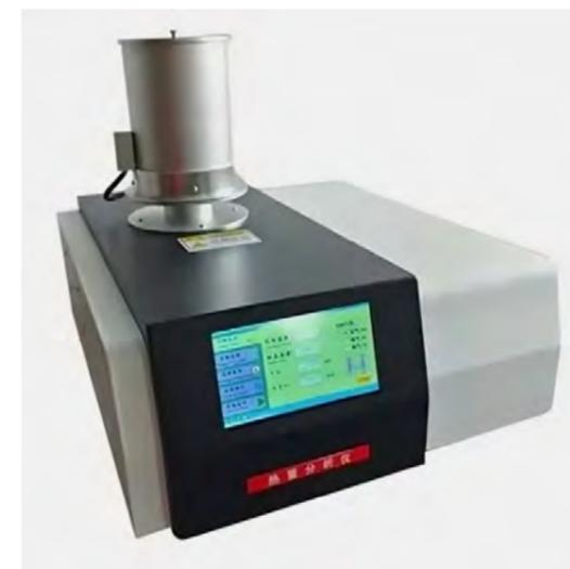
**Материаловедение:** может использоваться для исследования физических и химических свойств материалов, таких как металлы, полимеры, керамика и композиты. Исследования включают изучение фазовых переходов, деградации, разложения, сжигания и других процессов, которые происходят при нагревании или охлаждении.
