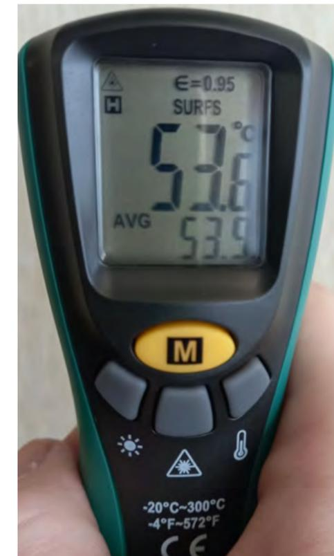
Инфракрасный термометр (пирометр) – прибор, предназначенный для бесконтактного измерения температуры (обнаружения исходящего ИК-излучения) различных объектов. Пирометр фокусирует ИК-лучи на датчик с помощью линз. Датчик переводит температуру на поверхности объекта в электрический сигнал, а микроконтроллер вычисляет температуру поверхности измеряемого объекта и выводит ее значение на ЖК-дисплей.
