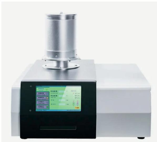
ZXF-A – это термогравиметрический анализатор исследовательского класса.
