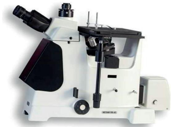
Микроскоп МЕТАМ ЛВ является новым поколением инвертированных металлографических микроскопов, предназначенных для исследования микроструктуры металлов, сплавов и других непрозрачных объектов.
