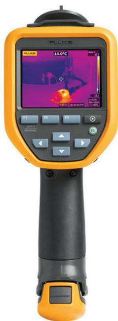
Портативный прибор для диагностики отопительных систем, электрооборудования, жилых помещений и др. в диапазоне от  $-20\text{ }^{\circ}\text{C}$  до  $+400\text{ }^{\circ}\text{C}$  с точностью  $\pm 2\text{ }^{\circ}\text{C}$ .
