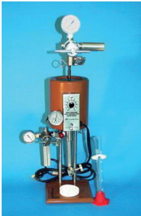
Фильтр-пресс высокого давления и температуры предназначен для тестирования буровых растворов при повышенных температурах и давлениях в соответствии со стандартами API RP 13B / ISO 10414.
