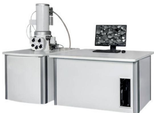
Применяется для получения изображений поверхности образца с высоким пространственным разрешением. Анализ химического состава производится при помощи спектрометра характеристического рентгеновского излучения (EDS).
