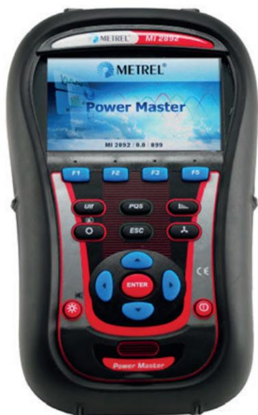
Портативный многофункциональный прибор, предназначенный для анализа качества электрического питания и измерения энергоэффективности. Оснащен большим цветным дисплеем, обеспечивающим легкое восприятие результатов измерений.
