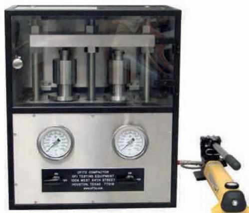
Исследование характеристик набухания глинистых сланцев важно при выборе бурового раствора, который должен обеспечить максимальное ингибирование и стабильность буровой скважины. Если буровой раствор не полностью совместим с пластом, то в процессе бурения скважины глина сразу начнет набухать. В результате набухания могут возникнуть проблемы следующего характера: налипание породы на долото, сопротивление трубы, обрушение стенок скважины и т.д.
