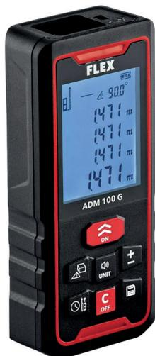
Предназначен для измерения расстояния, а также определения объема помещения по трем измерениям в рамках проведения энергетического обследования зданий.
