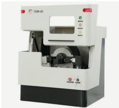
TDM-20 является многофункциональным настольным дифрактометром для решения широкого круга задач порошковой дифрактометрии: качественный и количественный фазовый анализ, определение параметров элементарной ячейки, размера кристаллитов, степени кристалличности, высокоскоростная съемка образца.
