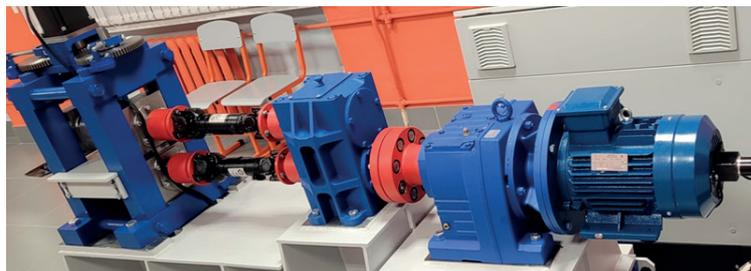
Комплект оборудования лабораторного прокатного стана ДУО-130 предназначен для проведения научно-исследовательских работ по изучению особенностей пластической деформации, физического моделирования процессов прокатки, проверке адекватности математических моделей, созданию цифровых двойников при 3D-моделировании.
