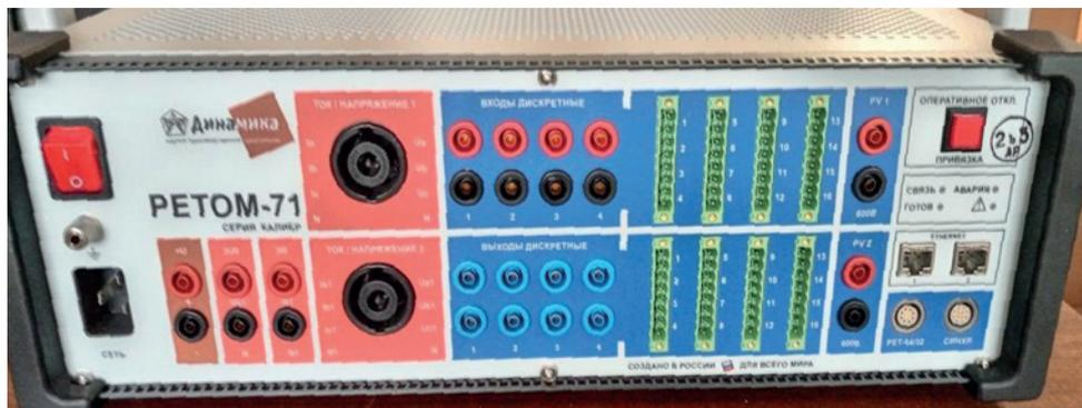
РЕТОМ-71 – испытательный комплекс серии «Калибр» в линейке РЕТОМ, ориентированный на проведение высокоточного тестирования сложных современных защит, а также метрологической поверки счетчиков электроэнергии и т. д.
