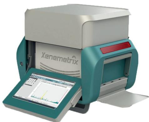
Настольный энергодисперсионный рентгенофлуоресцентный спектрометр высокого разрешения прямым и вторичным возбуждением для неразрушающего качественного и количественного определения элементов. Эффективный и экономичный портативный рентгенофлуоресцентный спектрометр, предназначенный для определения состава порошков, жидкостей, сплавов, а также массивных и спрессованных образцов.
