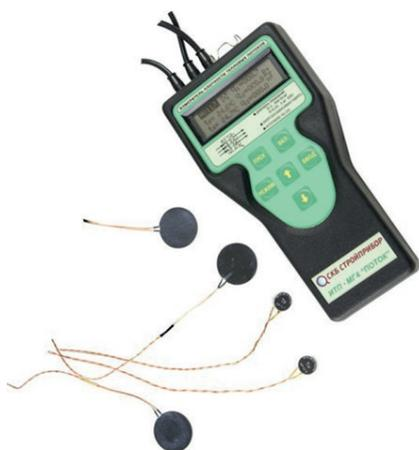
Предназначен для измерения плотности тепловых потоков, проходящих через однослойные и многослойные ограждающие конструкции зданий и сооружений по ГОСТ 25380, через облицовку и теплоизоляцию энергообъектов при экспериментальном исследовании и в условиях эксплуатации. Приборы позволяют измерять температуру воздуха внутри и снаружи помещения, а также измерять плотность тепловых потоков.
