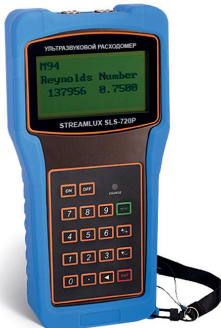
Предназначен для бесконтактных измерений на трубах из практически любого материала: металл, пластик, стекло и многие другие. На металлических трубах датчики можно закрепить на встроенных магнитах.
